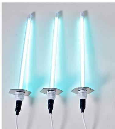
La serie UV-STYLO-X comprende una scelta di modelli pensati per installazioni in spazi molto ristretti. Il device è composto da una flangia esagonale in acciaio INOX AISI 304 sulla quale è alloggiata una lampada UV-C protetta da un bulbo di quarzo puro.
